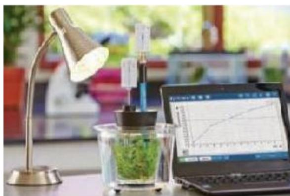
**Capteur de pH ou CO2 relié à une station pour analyser l'évolution des données en SVT**
