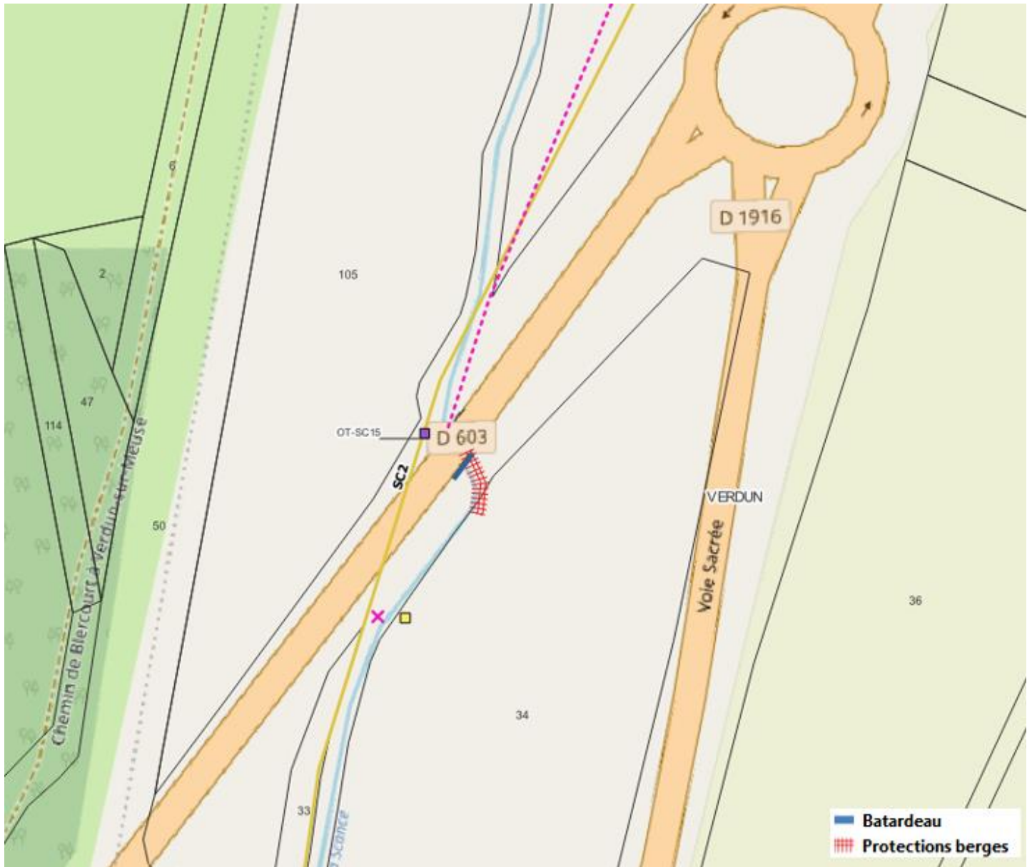
Travaux envisagés par le Département (enrochement en protection de la pile du pont, en amont, et en rive gauche de la Scance)
